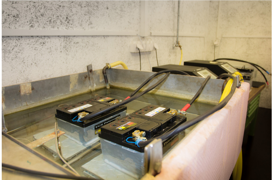
Im Wasserbad werden die vorgeschriebenen Batterie-Temperaturen konstant gehalten.
